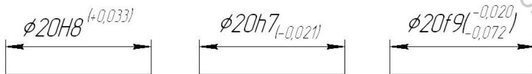
Рисунок 1.5 – Обозначения классов допусков смешанным способом
