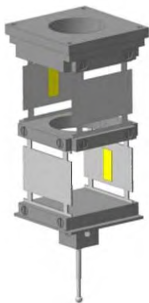
Рисунок 5.18 – Двухкоординатная ИГ отклонения на основе пружинных параллелограммов
