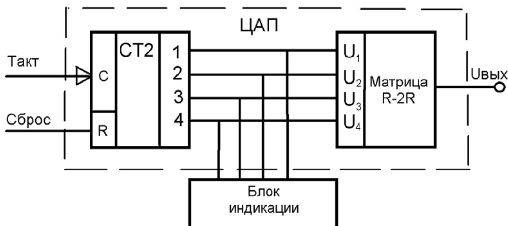
Рисунок 7.2 – Схема 4-разрядного ЦАП
