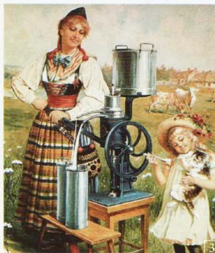
3. Молочный сепаратор Г. де Лавалья. Фирма «Сепаратор». 1887 г.
