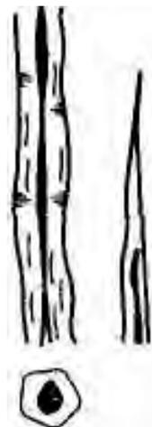
Рисунок 6.3 – Продольный вид и поперечный срез элементарного льняного волокна
