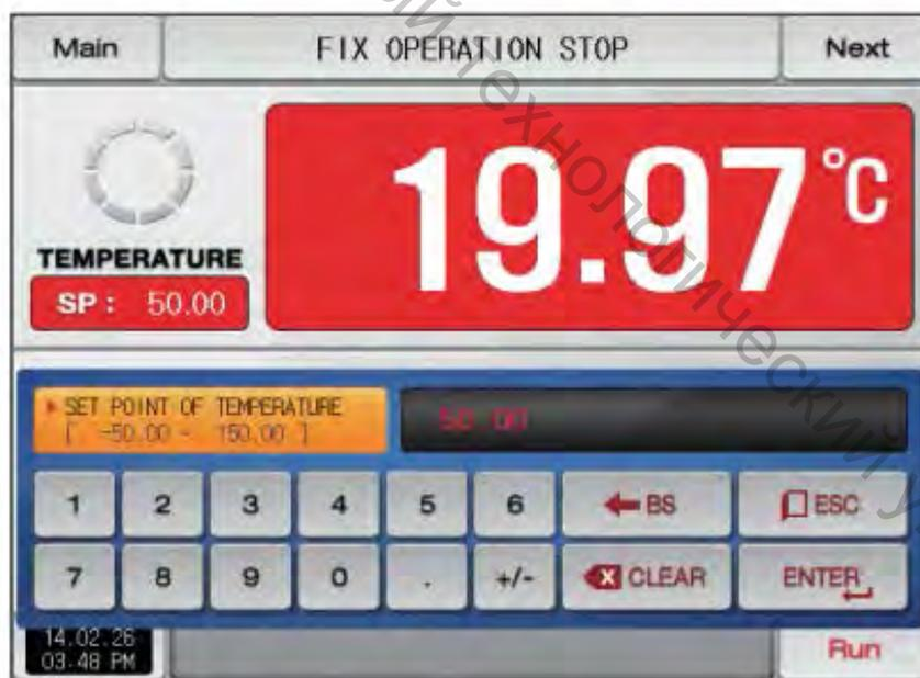
Рисунок 14.6 – Экран для установки температуры
