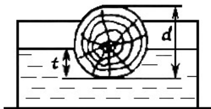
Рисунок 10.4 – Определение средней плотности древесины по погружению в воду образца-диска
