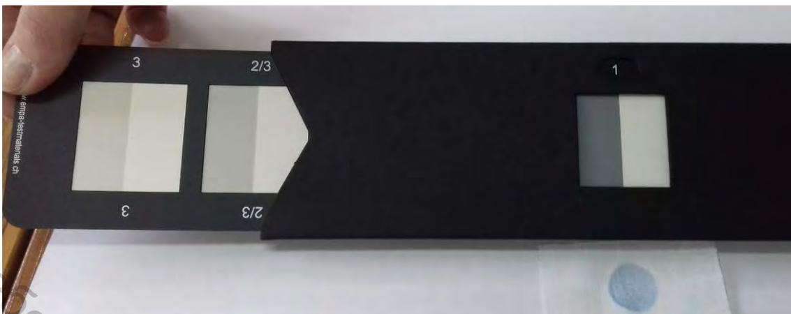
Рисунок 4.31 – Шкала серых эталонов для определения степени закрашивания белых материалов
