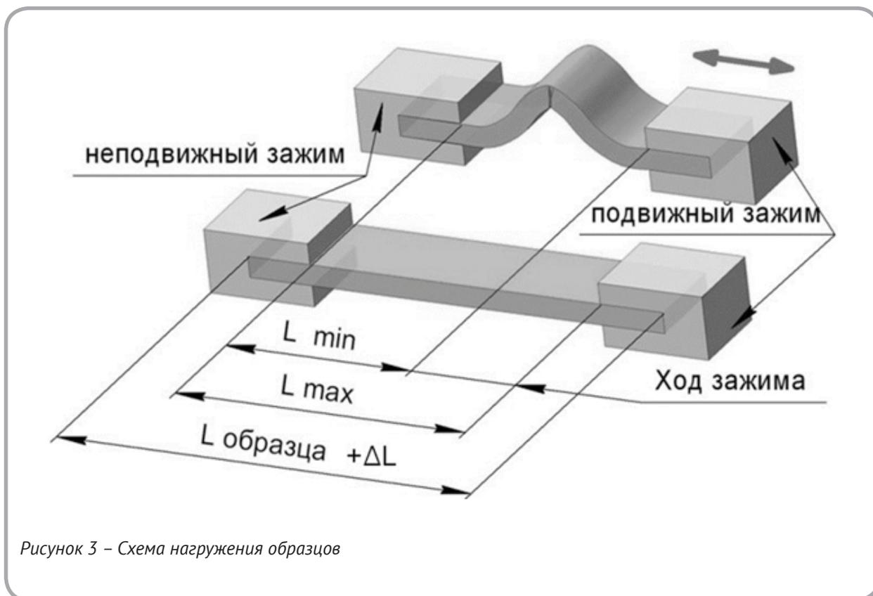
Рисунок 3 – Схема нагружения образцов
