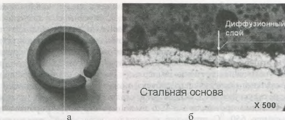
Рисунок 1 – а) Образец гравера, после термодиффузионного цинкования б) Микроструктура диффузионного цинкового слоя, X500
