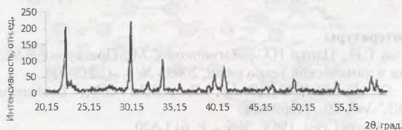
Рисунок 2 - Вид рентгенограммы керамики состава \text{BaAl}_2\text{Si}_2\text{O}_8 после синтеза
