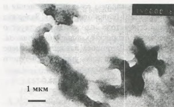
Рисунок 1 – Углеродные структуры в топливе I (ток 10мА)
