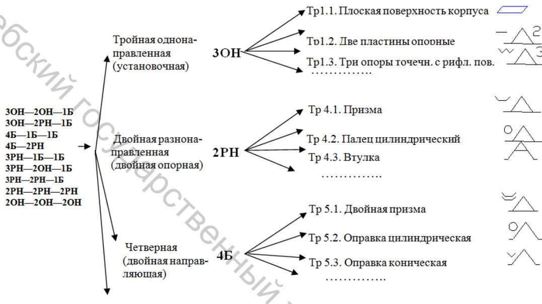
Рисунок 3.83 – Фрагмент схемы соответствия вида компонента возможным установочным элементам
