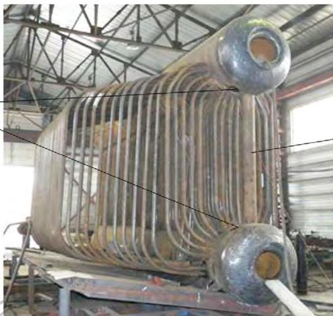
Рисунок 2.12 – Вид трубной системы котла производительностью 16 т/ч со стороны солевого отсека
