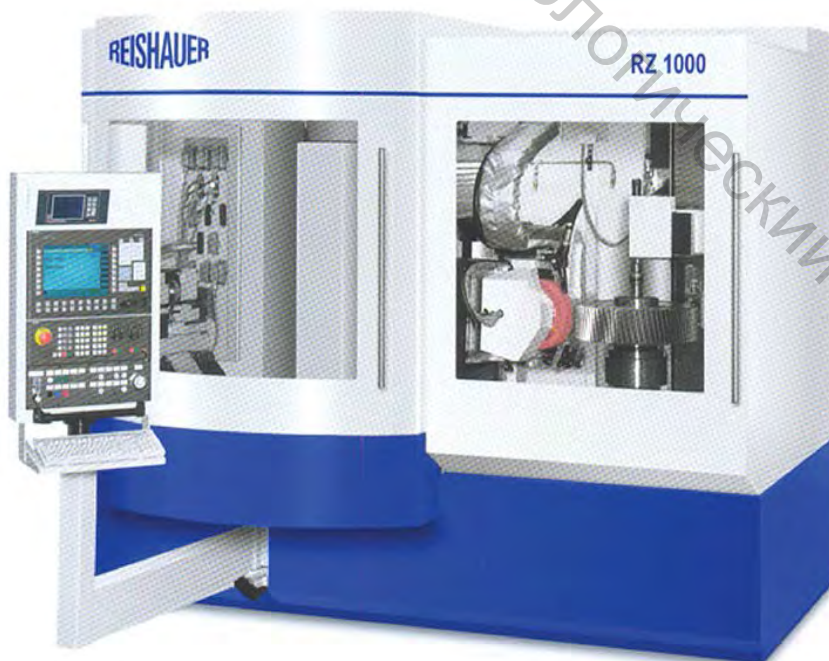
Рисунок 17.6 – Зубошлифовальный станок мод. RZ 1000 фирмы REISHAUER, работающий непрерывным обкатным методом ( m \leq 10\ \text{мм} , d \leq 1000\ \text{мм} )
