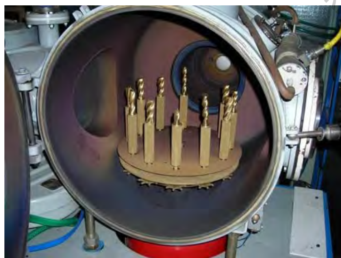
Рисунок 15.4 – Установка ионно-плазменного напыления
