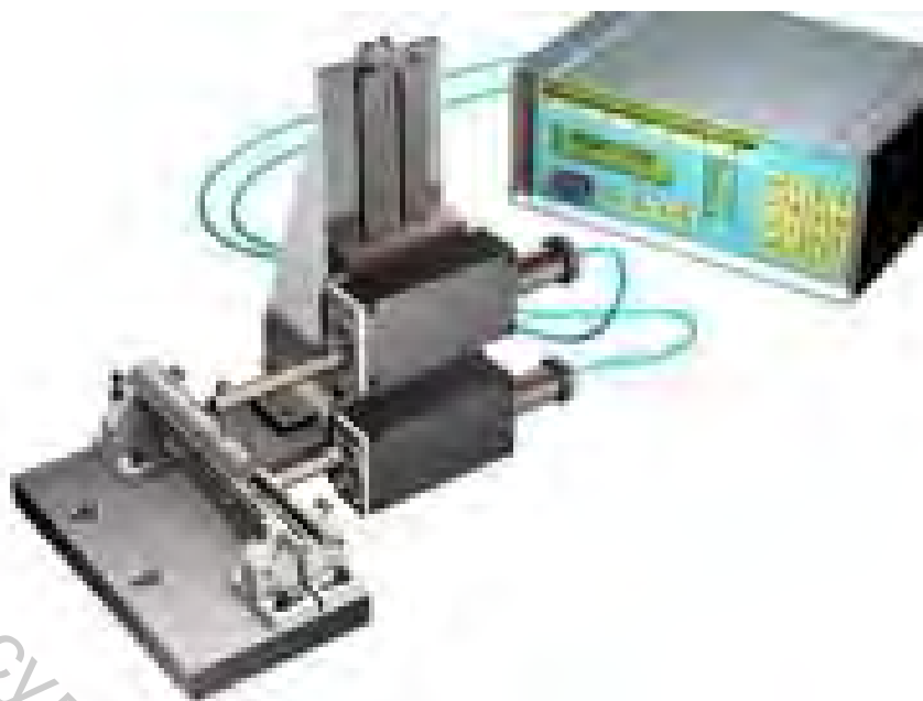
Рисунок 4.21 – Подналадчики для круглошлифовальных бесцентровых, токарных и сверлильно-фрезерно-расточных станков
