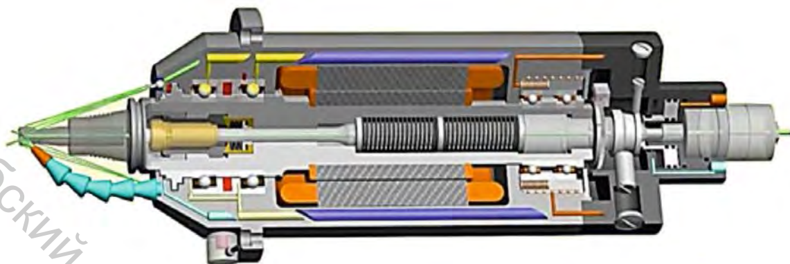
Рисунок 2.3 – Мотор-шпиндель с исполнительными элементами для контроля процесса высокоскоростной обработки
