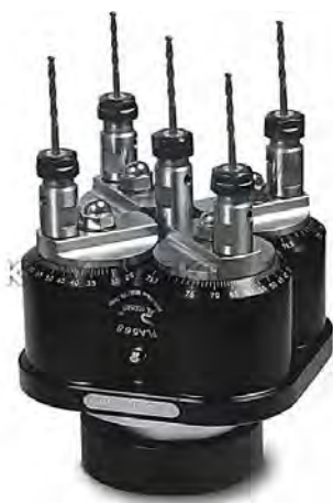
Рисунок 3.8 – Многошпиндельная сверлильная головка
