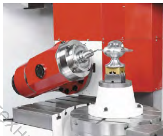
Рисунок 10.12 – Рабочие зоны 5-координатных станков с парой B+C
