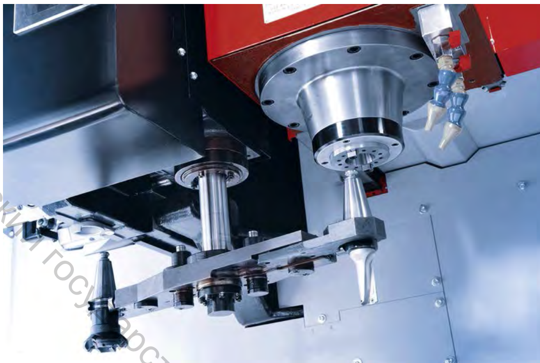
Рисунок 10.8 – Автооператор с двумя захватами для смены инструмента
