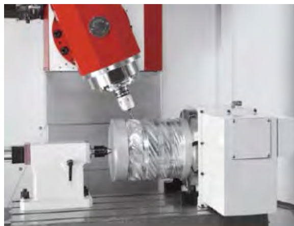
Рисунок 10.11 – Рабочие зоны 5-координатных станков с парой координат A+B
