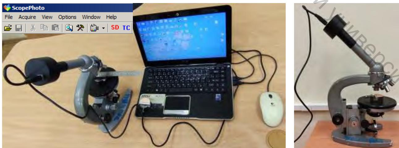
Рисунок 2.2 – Подключение камеры к микроскопу и ноутбуку
