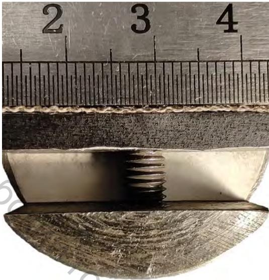
Рисунок 2.3 – Фиксация среза ткани в зажиме
