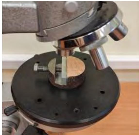
Рисунок 2.4 – Расположение зажима на предметном столике
