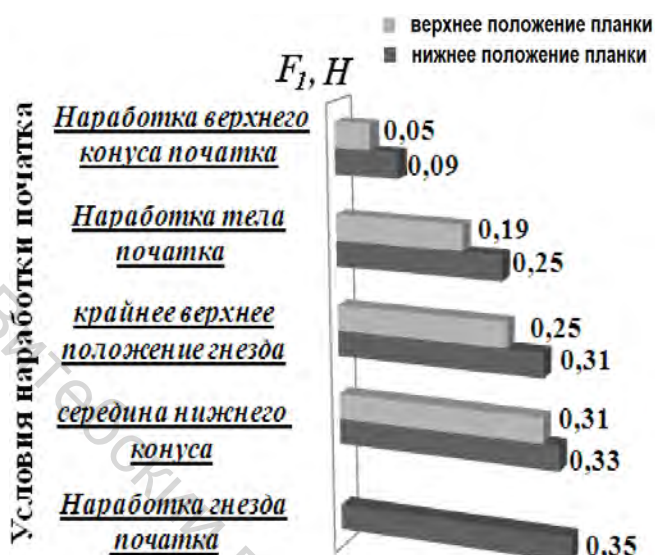
Рисунок 10. – Расчетные значения силы трения армированной нити о нитепроводник
