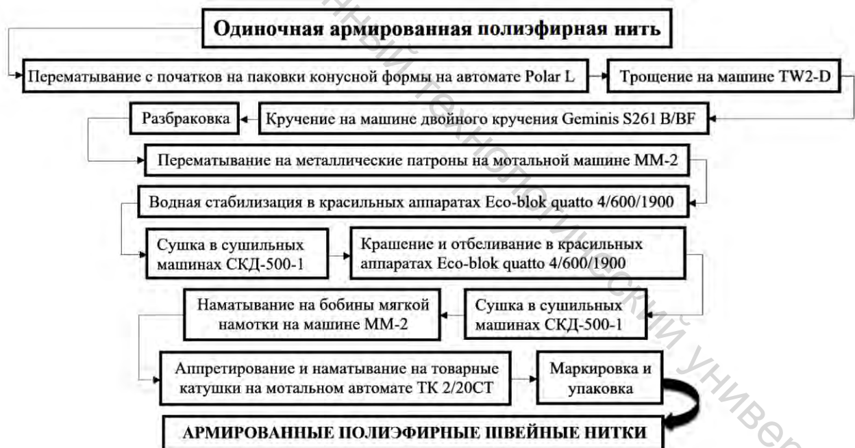
Рисунок 2. – Схема технологических переходов в крутильно-ниточном производстве для изготовления армированных полиэфирных швейных ниток
