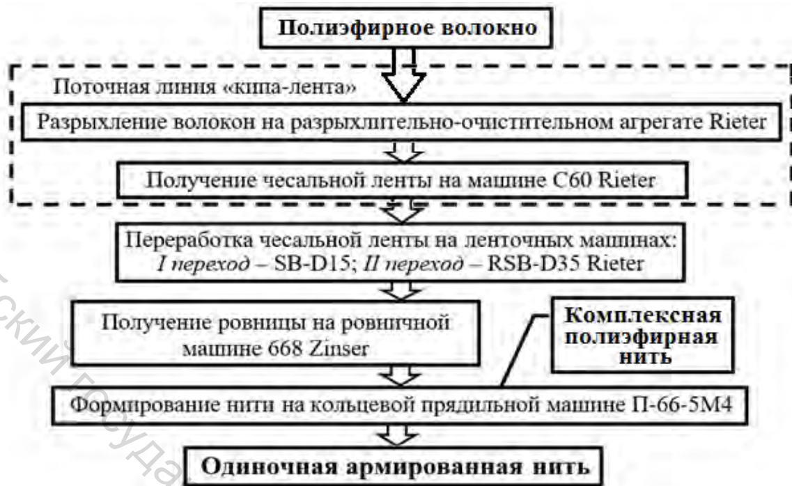
Рисунок 1. – Схема технологического процесса получения одиночной армированной нити в прядильном производстве
