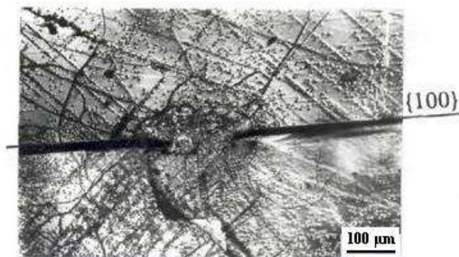
Рисунок 3 – Участок восстановившейся сплошности в русле трещины на поверхности скола перпендикулярного плоскости трещины. Положительно заряженная поверхность расположена выше русла трещины. LiF ( 10^{-3} вес. %)
