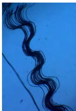
Рисунок 2.3 – Волокнистый состав нити: а – коренной основы, б – прижимной основы
