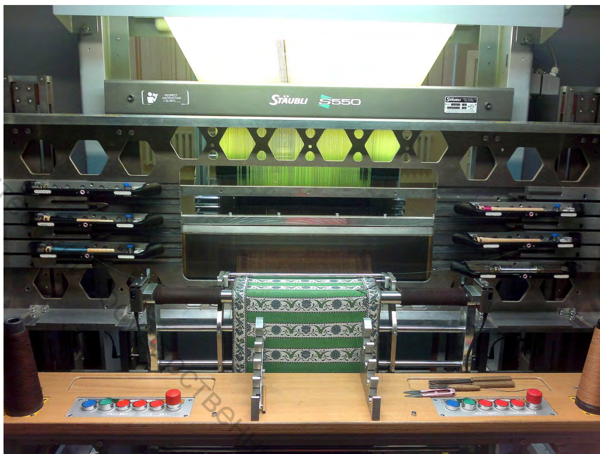
Рисунок 3.2 – Процесс изготовления копии слуцкого пояса на современном ткацком оборудовании
