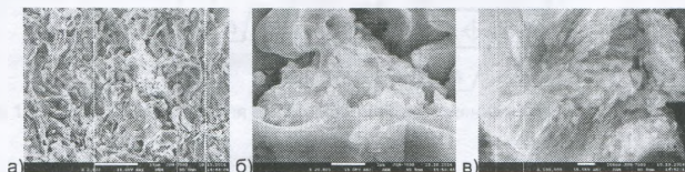
Рисунок 3 – Наноструктурированное TiNiHf покрытие, полученное высокоскоростным газопламенным напылением механически активированного порошка: \times 2500 – а); \times 20000 – б); \times 100000 – в)
