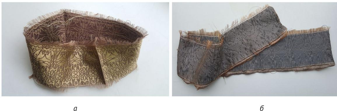
Рисунок 6 – Опытные образцы ткани полой структуры (а) и двойной ширины (б)
