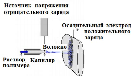
Рисунок 1 – Схема электроформования на установке Fluidnatek LE-50
