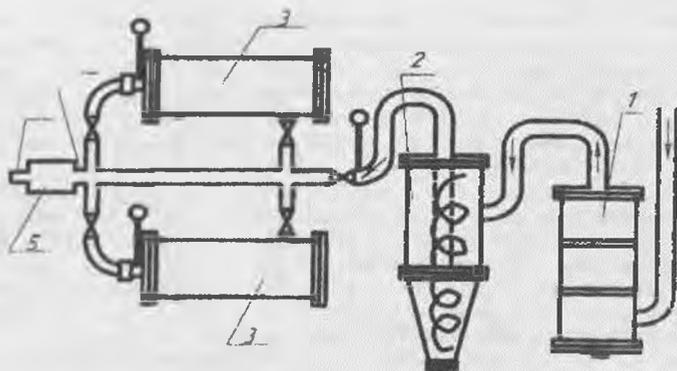
Рисунок 2 - Схема установки для очистки воды от оксидов железа и марганца с помощью пираюзитовой крупки
