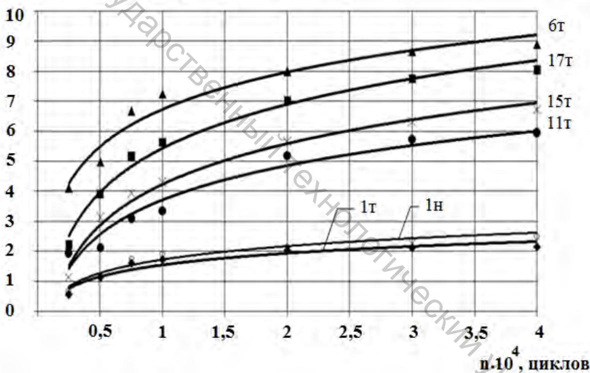
Рисунок 3.12 – Зависимость циклической формоустойчивости от числа циклов деформирования
