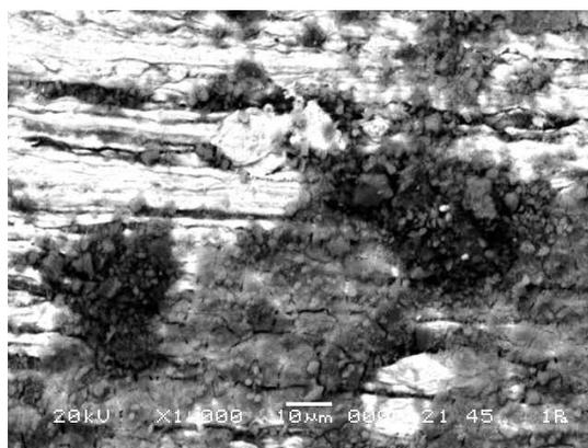
Рисунок 6 – Микроструктура поверхности фибры, обработанной антикоррозионной композицией, содержащей глину, до закладки в бетон
